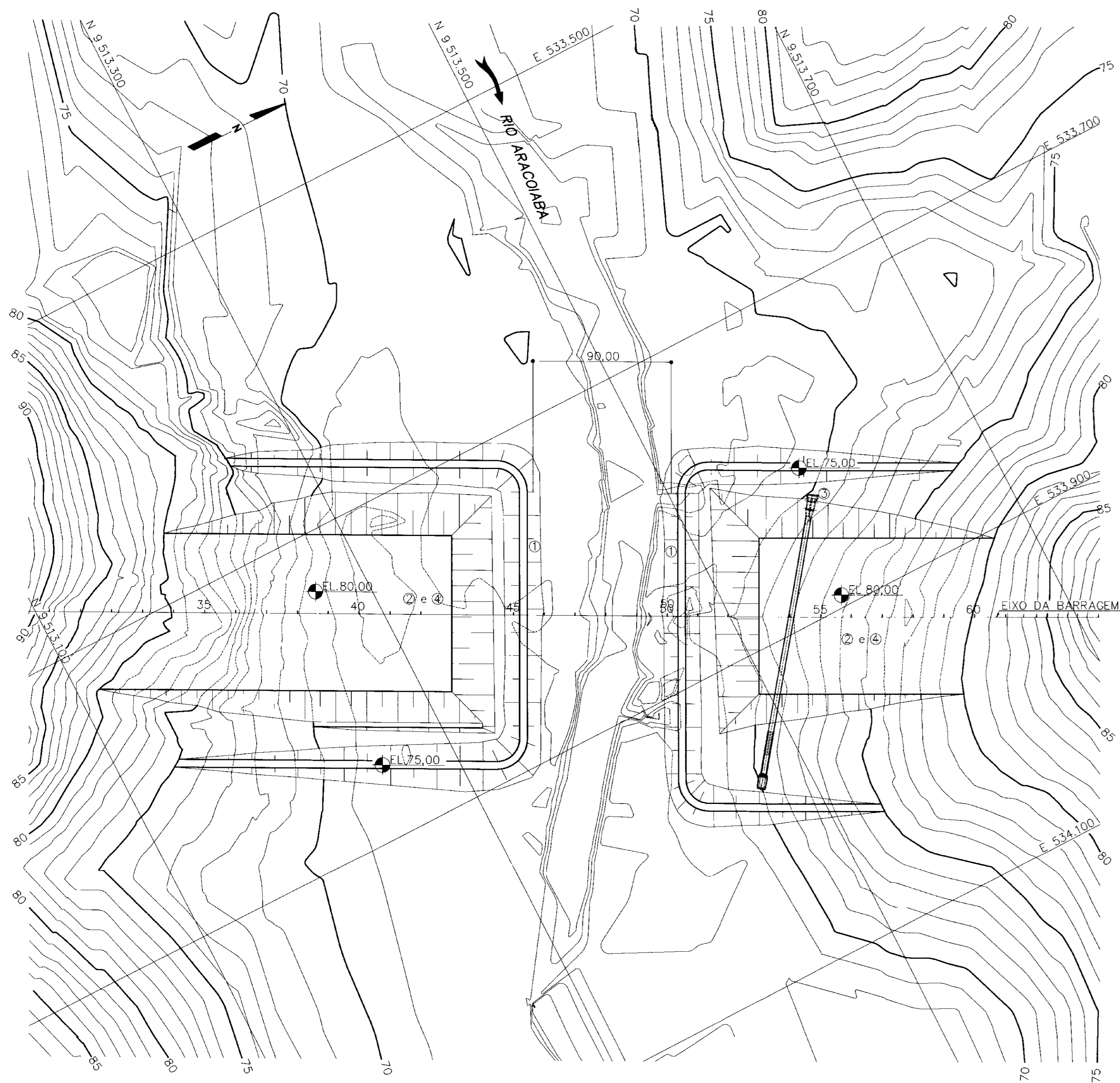
FASE 1 – RIO ESCOANDO PELA BRECHA CENTRAL PRAZO DE EXECUÇÃO – 10 MESES
